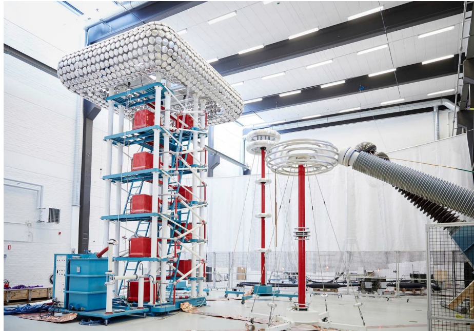
Figura 3.17 – Laboratório para testes de alta de tensão, tendo ao centro o gerador de impulsos e divisores de tensão
