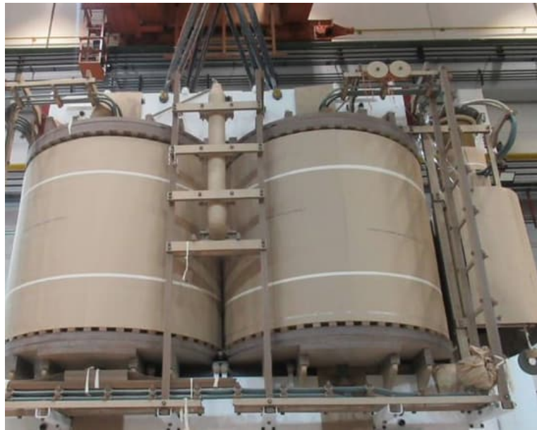
Figura 4.2 – Parte ativa de transformador de potência monofásico montado com comutador de derivações em carga
