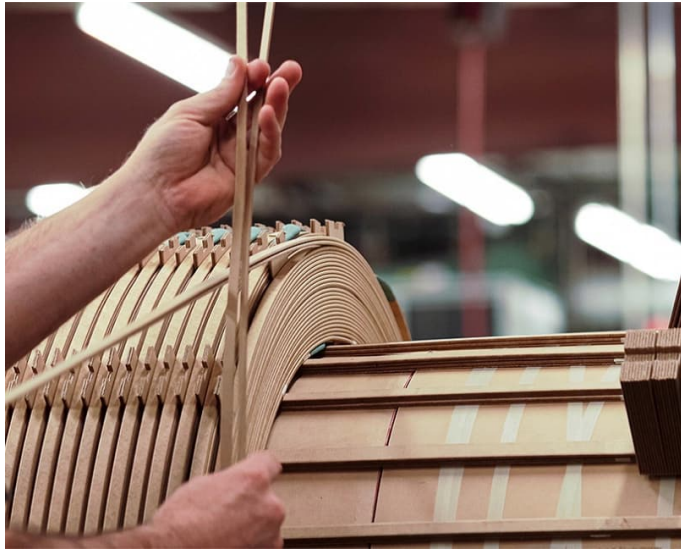
Figura 4.10 – Enrolamento tipo disco utilizado para altas tensões
