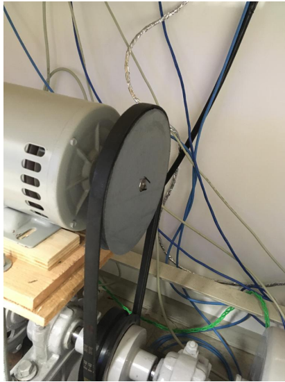
Figura 25 – Máquina de indução trifásica e inversor empregados como força motriz do gerador.
