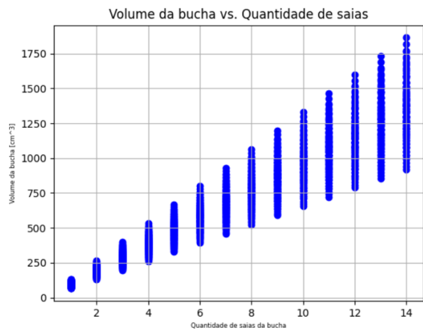
Figura 10 – Características de uma bucha vs. quantidade de saias
