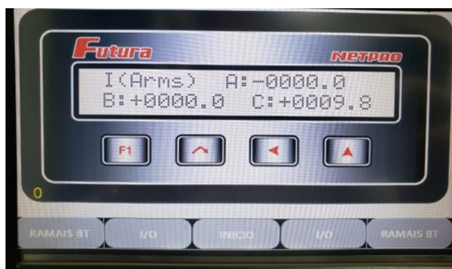
Figura 77 – Corrente com potência positiva transitando pelo Protetor de Redes ao ligarmos todas as cargas e a UFV ao mesmo tempo.
