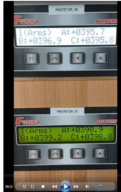
Figura 35 - Fechamento do Protetor_01 e Protetor_02: corrente de carga dos consumidores da rede da concessionária na ordem de 800 A trifásico (aprox. 400A em cada um dos dois Protetores de Redes), correntes no display dos relés considerando-se TC de 400:1 injetadas diretamente nos relés 01 e 02 pelo Testador CE-7012: t = 23 s
