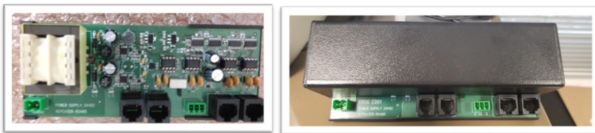
Figura 44 – Fonte de alimentação com dupla alimentação, com repetidor 485 embutido, a ser utilizada no projeto como repetidor/amplificador do sinal 485: a) vista interna; b) com case de instalação.
