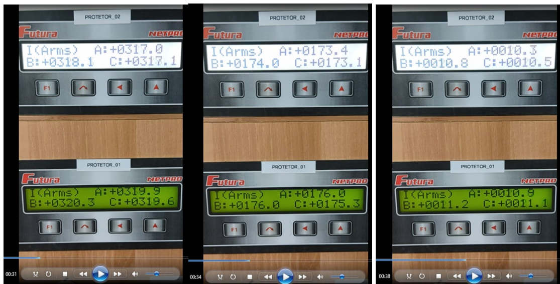
Figura 36 - Efeito do aumento da corrente de Geração Distribuída - IGA, mantendo-se a carga dos consumidores constante em \sim 800 A, sendo verificada como decréscimo da corrente trifásica fornecida pelos transformadores da rede da concessionária - IRC, através dos Protetores 01 e 02, em 3 momentos distintos na simulação
