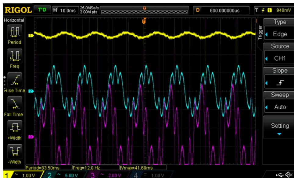
Figura 80 – Oscilograma de registro inicial, com UFV e todas as cargas ligadas
