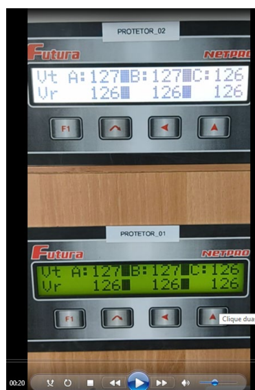
Figura 34 - Inicialização: tensões de transformador e de rede gerados pelo Testador CE-7012: t = 20 s
