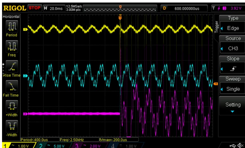
Figura 82 – Oscilograma de transitório inserindo-se carga (I).
