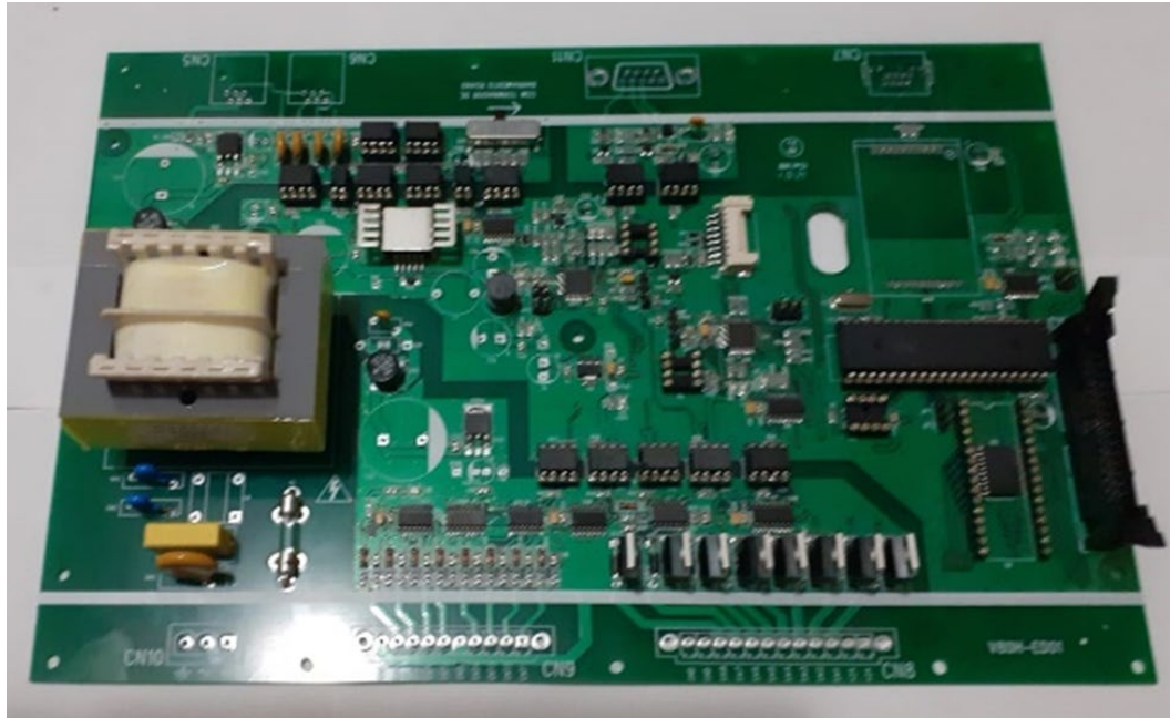
Figura 6 – Placa PCB modelo V-80H, montada com componentes
