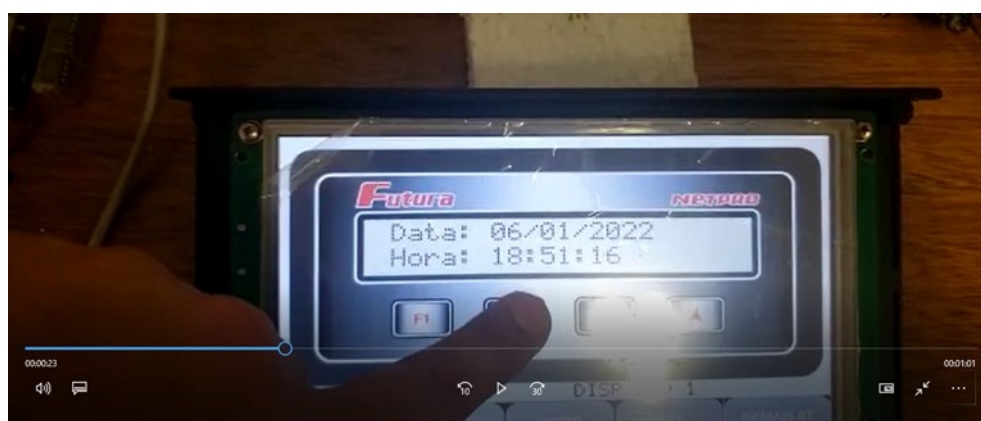
Figura 54 – C-GD (placa V80H + display 7”) emulando tela do relé de proteção do equipamento Protetor de Redes: tela de data e hora.
