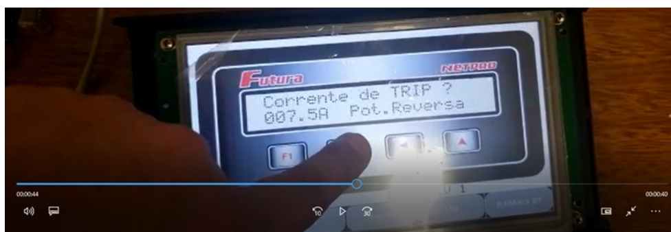
Figura 57 – Tela do C-GD (placa V80H + display 7”) emulando tela do relé de proteção do equipamento Protetor de Redes: tela de entrada de ajustes de SETUP do relé – ajuste de trip da corrente instantânea em potência reversa.
