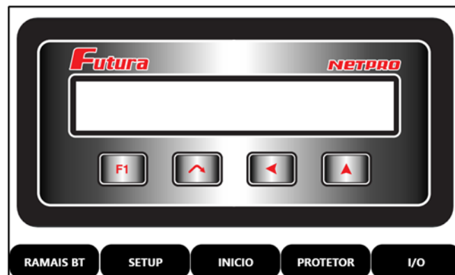
Figura 60 – Telas do menu PROTETOR: emula as funções do relé atual do Protetor de Redes.
