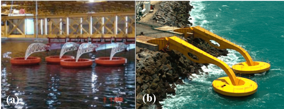
Figura 4.10: Esquerda: modelo do protótipo em teste em tanque de ondas; Direita: usina do porto de Pecém-CE. Fonte: Shadman et al. (2019).
