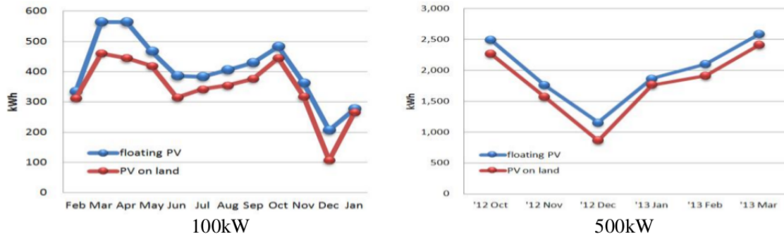
Figura 5.4: Comparação da energia média gerada das plantas flutuantes (azul) com a planta em terra (vermelho). Fonte: Choi (2014).
