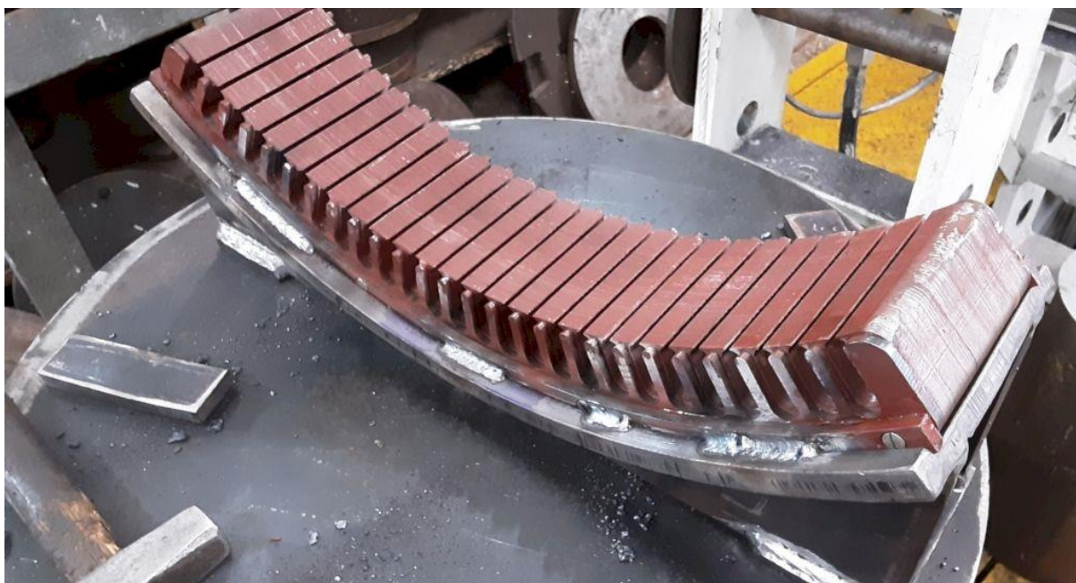
Figura 33 – Primário no estágio de montagem do núcleo magnético
