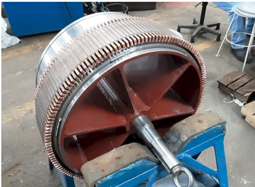
Figura 36 – Secundário ranhurado no estágio da montagem da gaiola em cobre
