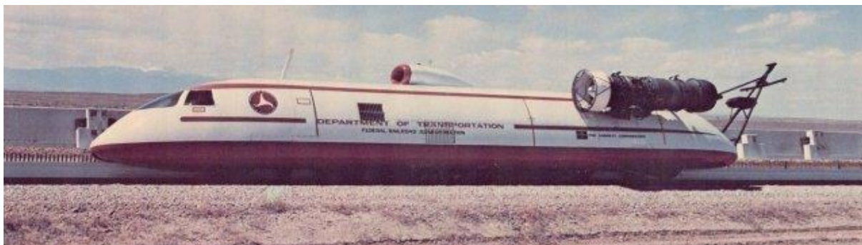
Figura 6 - O LIMRV da Garrett Co., capaz de atingir até 400 km/h
