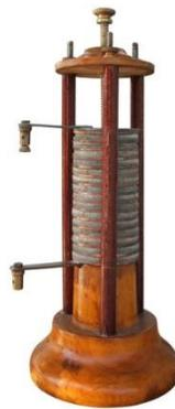
**Figura 1 - Pilha de Volta.**
