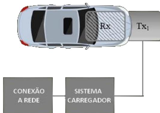
**Figura 13 - Recarga indutiva por meio de equipamento estático.**
