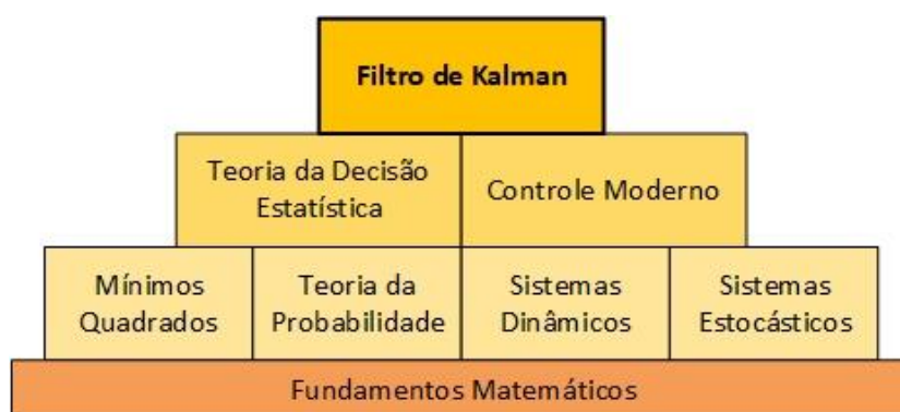
Figura 2.14 - Conceitos fundamentais do filtro de Kalman.
