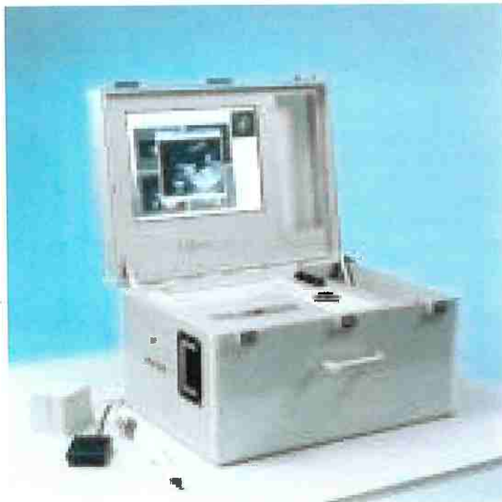
Figura 2-3 – Estação portátil do TeleInVivo (Coleman et al., 1997)
