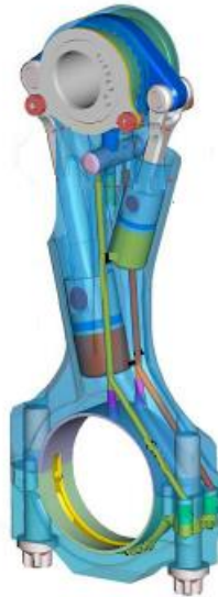
Figura 7 – Motor VCR com Pistão com Variação de Altura.
