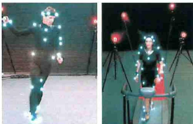
**Figura 4.3:** Sistema de captura de movimento ótico, Troje (2003)
