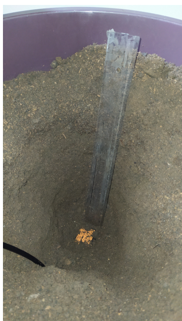
Figura 27: Sensor posicionado ao fundo (MTEC Bottom). Figura 28: Sensor posicionado ao topo (MTEC Up).
