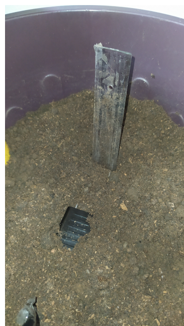
Figura 27: Sensor posicionado ao fundo (MTEC Bottom). Figura 28: Sensor posicionado ao topo (MTEC Up).
