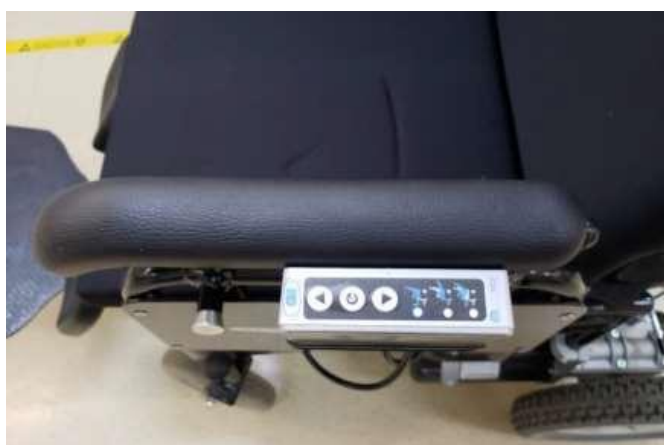
Figura 33 - Painel do CONTAV inserido em uma CR motorizada.
