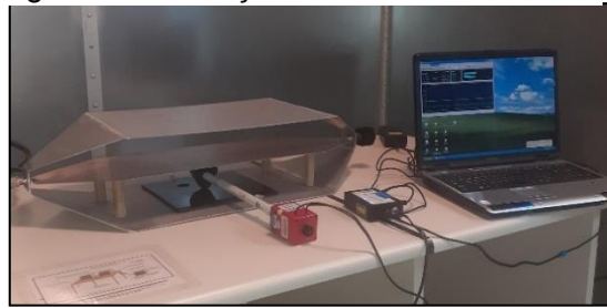
Figura 37 - Medição na célula TEM
