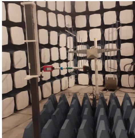
Figura 36 - Configuração do ensaio na câmara anecóica.
