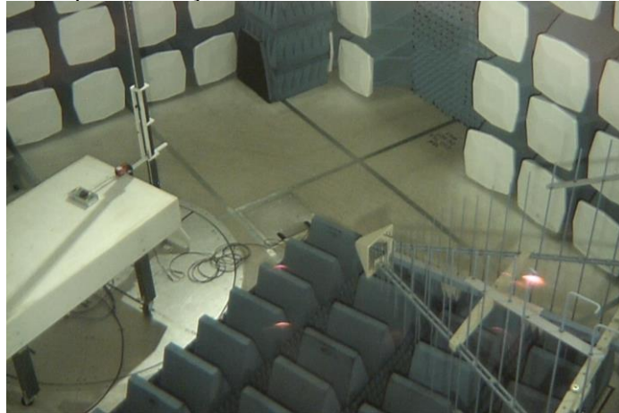
Figura 44 - Setup de medição dentro da câmara anecóica com blindagem
