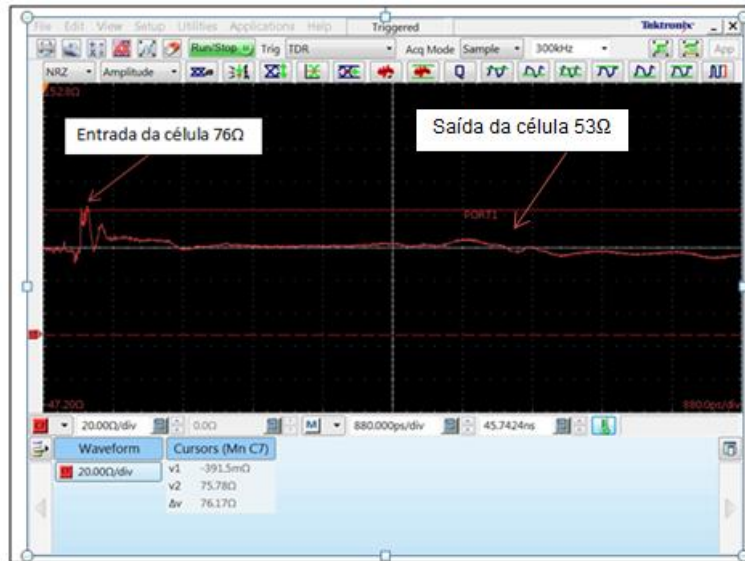
Figura 19 - Variação da impedância ao longo da célula com novo septo.
