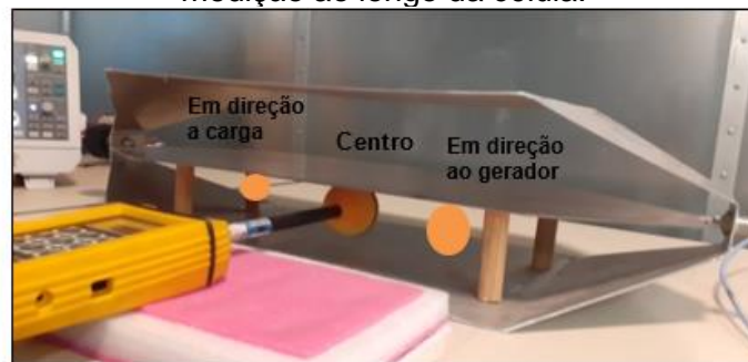
Figura 21- Medição do campo na célula com septo modificado. Posição dos pontos de medida ao longo da célula.
