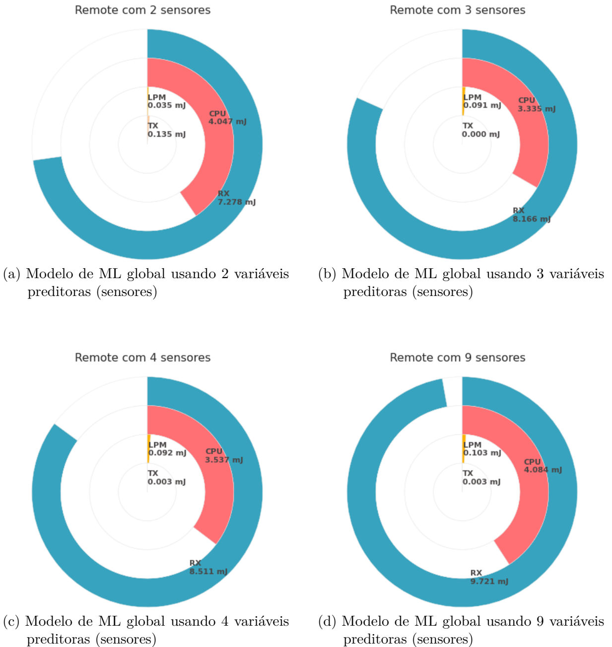
Figura 19 – Consumo de energia do dispositivo Remote para o recebimento da mensagem 1 para estruturação das variáveis do modelo de ML global
