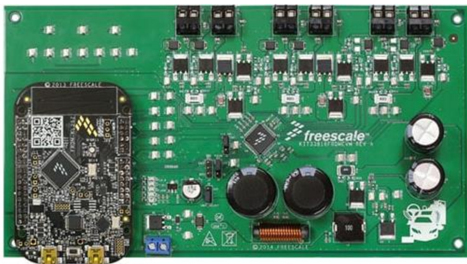
Figura 11 – Kit de desenvolvimento utilizado para o controle dos injetores.
