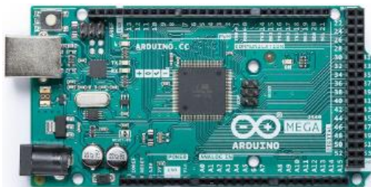
Figura 67 - Microcontrolador Arduino MEGA 2560 Fonte: autor com base em (ARDUINO, 2022).
