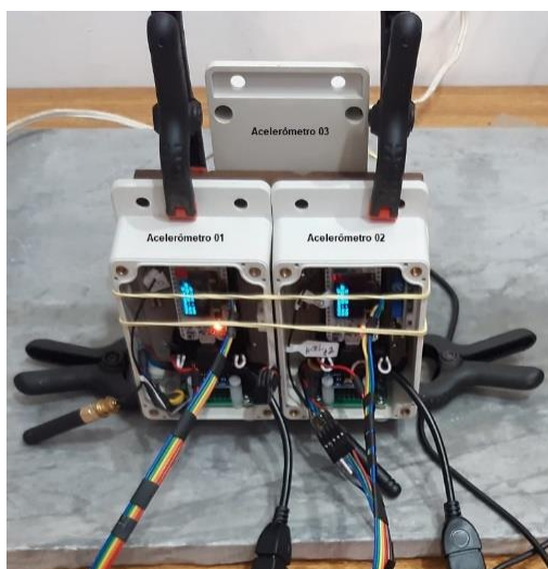
Figura 26 - Experimento de teste dos acelerômetros MPU 9250 Fonte: autor.
