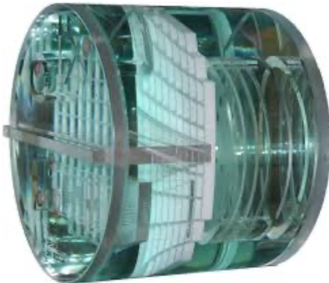
Figura 3: Exemplo de um phantom multipropósito com design recomendado pelo ACR.
