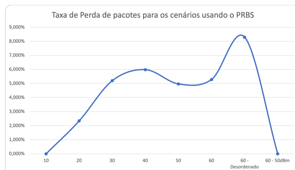
Figura 14 – Consolidado das médias de taxa de perda de pacote para os cenários usando o protocolo PRBS.
