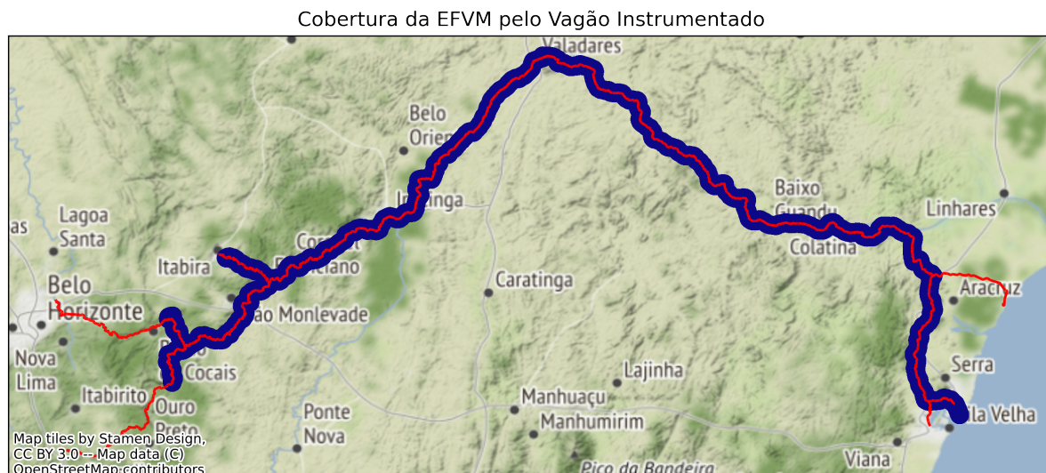
Figura 31 – Cobertura do VI sobre a EFVM. Os pontos em azuis representam uma captura de dados. O traçado em vermelho representa a EFVM.
