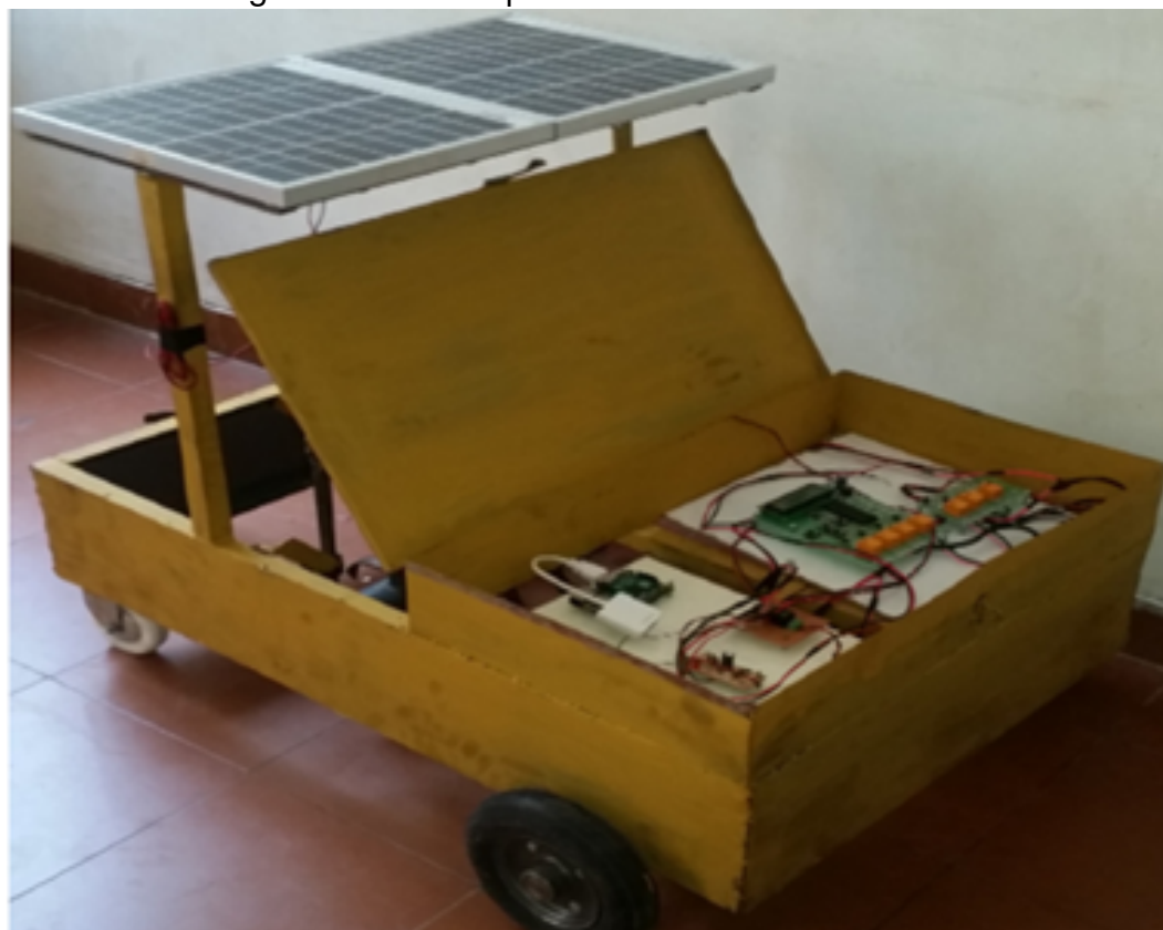
Figura 13 - Robô que identifica ervas daninhas.
