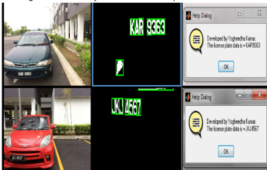
Figura 3 - Identificação de caracteres de placas de automóveis.
