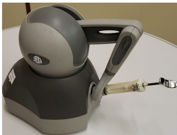
Figura 13 – Dispositivo háptico com seringa acoplada.
