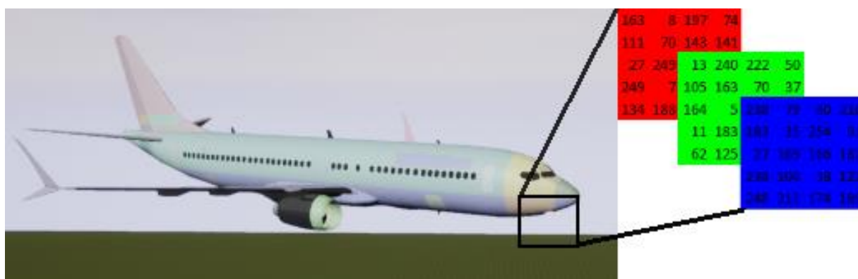
Figura 14: Representação de uma imagem por meio de matrizes de cores [Próprio].
