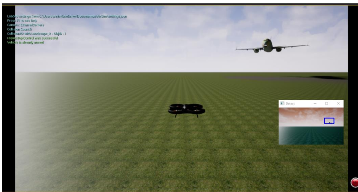
Figura 35: Ilustração do ambiente em funcionamento da simulação via framework . No quadro à direita da imagem mostra-se a detecção visual da aeronave por parte do VANT [Próprio].
