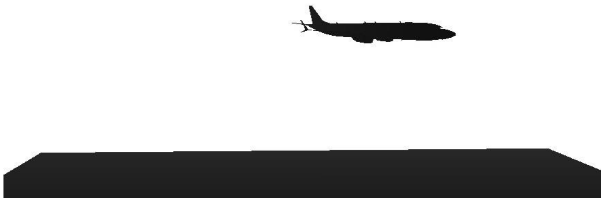
Figura 16: Aeronave detectada por uma imagem de profundidade. Na imagem, quanto mais claro o pixel , mais distante está o objeto capturado. [Próprio]
