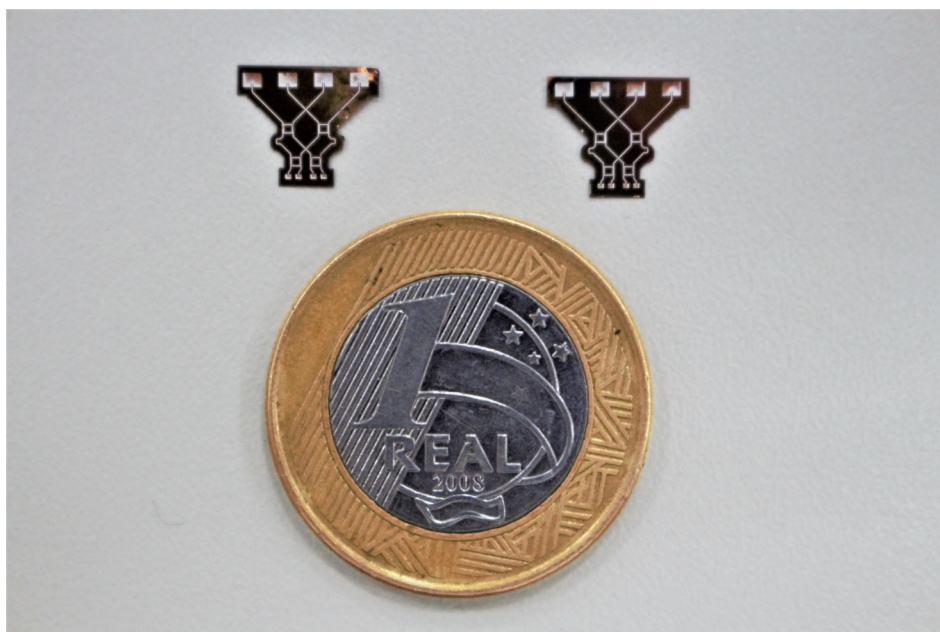
Figura 50 – Par de Matrizes de Butler 4 \times 4 , fabricadas na tecnologia MnM e acopladas a um array linear de antenas patch
