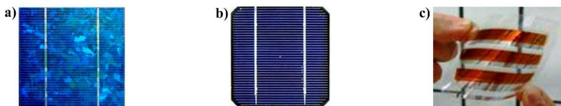
Figura 3. Células solares fotovoltaicas inorgânicas de a) silício policristalino e b) silício monocristalino, e c) célula solar orgânica flexível.
