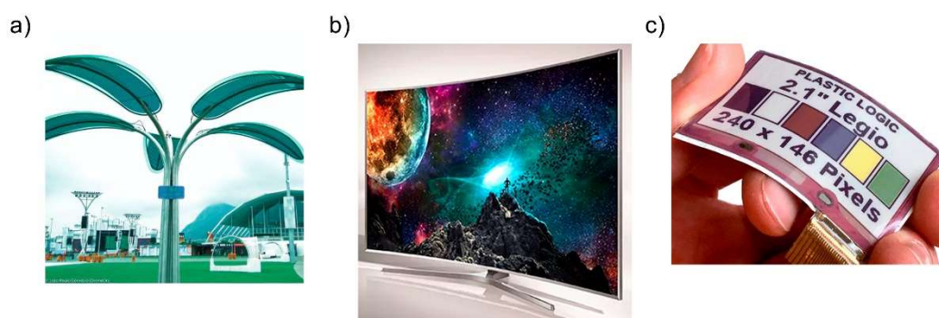
Figura 7. Dispositivos orgânicos aplicados em tecnologias. a) árvore com folhas de painéis solares colocados em áreas públicas para carregar aparelhos com baterias como celulares. b) Tv com tela de OLED. c) placas sinalizadoras de 6 cores, futura aplicação em vestíveis.
