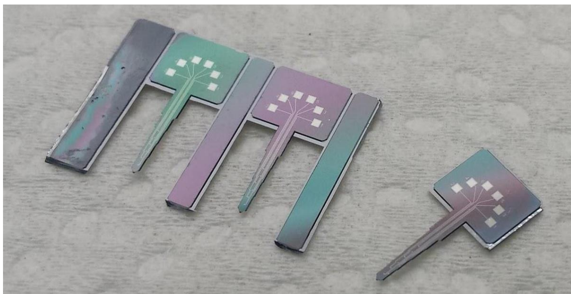
Figura 32 - Microagulhas após a corrosão.
