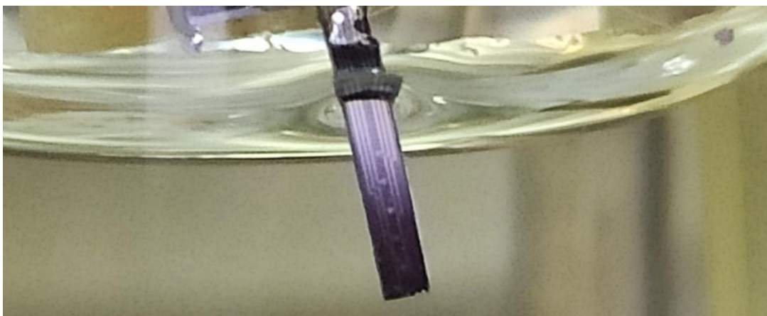
Figura 52 - Versão 5 - Eletrodeposição de ouro nos microeletrodos.
