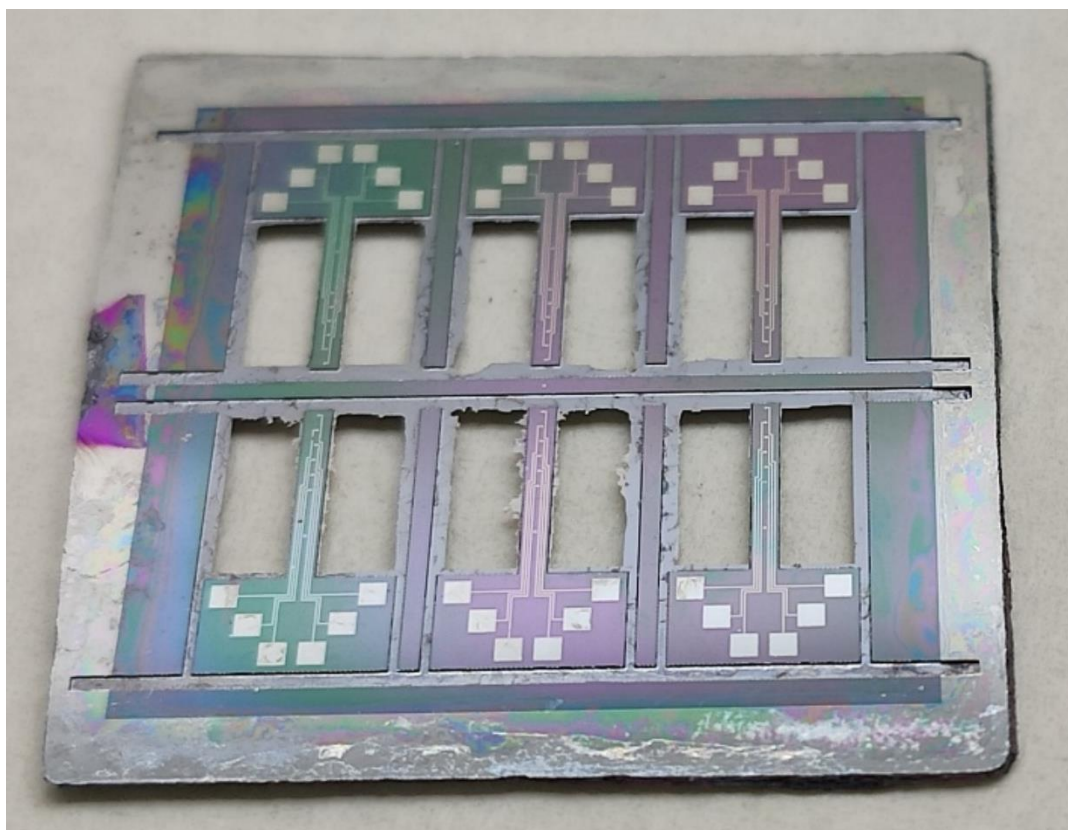
Figura 49 - Versão 5 – Amostra após o processo de corrosão.
