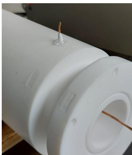
Figura 4-27: Detalhe da fixação do eletrodo de cobre no corpo da câmara IMS
