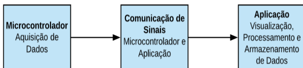
Figura 4: Esquema das funcionalidades entre o módulo eletrônico e a aplicação.
