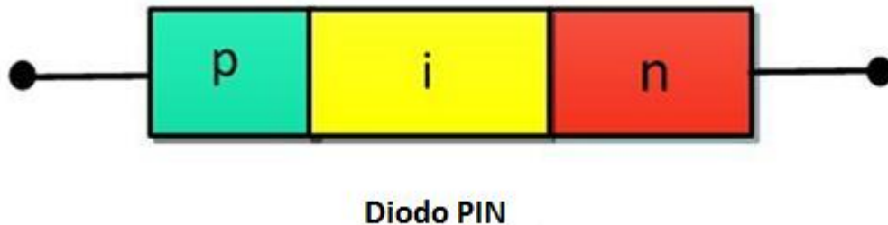
Figura 2.8 – Representação simplificada da estrutura interna de um diodo PIN Fonte: Adaptado da referencia [20].
