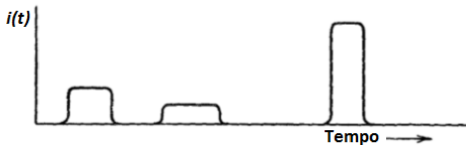
Figura 2.4 – Pulsos de corrente independentes representando interações individuais supondo a taxa de geração suficientemente baixa. Fonte: Adaptado da referencia [9].
