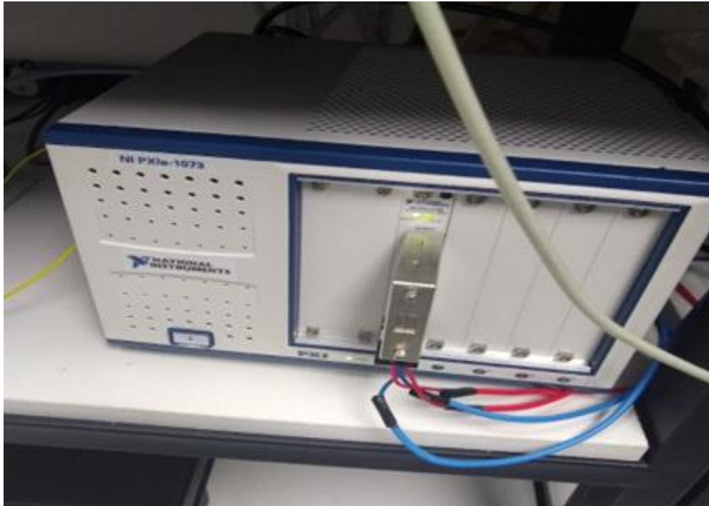
Figura 3.7 – Foto da DAC da National, modelo NI PXIe – 1073 empregada nas medidas elétricas. Fonte: o próprio autor
