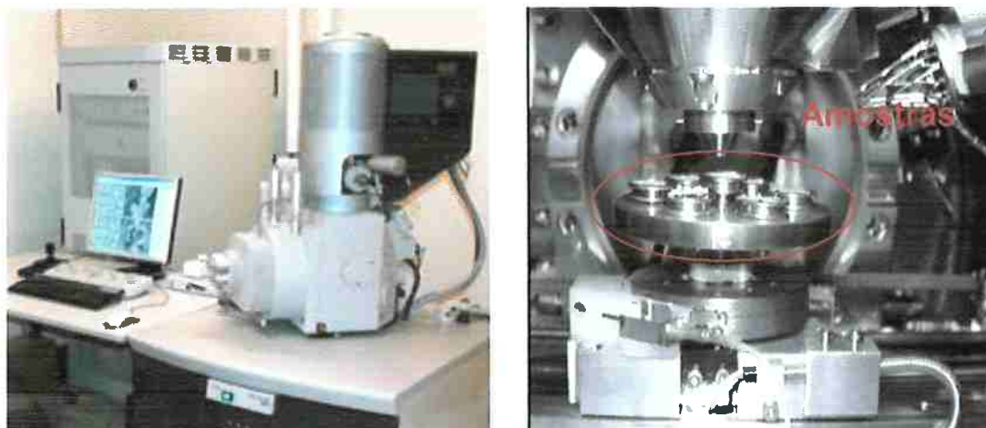
Figura 3.4- (a) Microscópio Eletrônico de Varredura (EPUSP); (b) Posicionamento das Amostras em fita de carbono.
