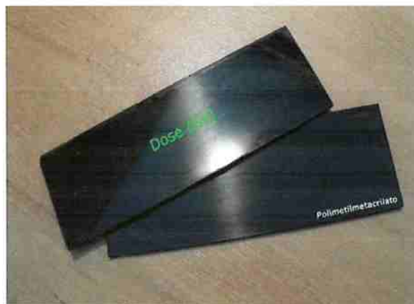
Figura 3.7- Placa de Polimetilmetacrilato utilizada para transporte das amostras.
