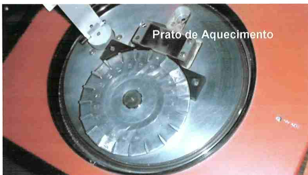
Figura 3.14-Sistema de aquecimento da DayBreak utilizado para obtenção do espectro TL.
