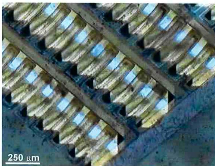
Figura 33. *Cantilevers* de 300 μm de matriz alinhada.
