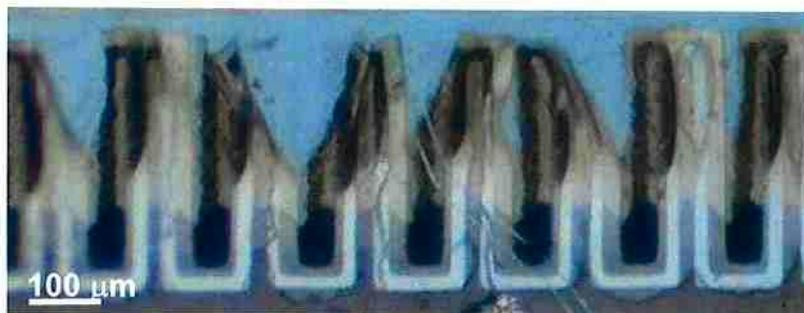
Figura 42. Deformação de *cantilever* devido a correntes superiores a 22,5 mA.
