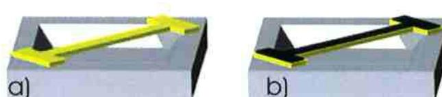
Figura 23. Processo de metalização das micropontes por *lift-off*.
