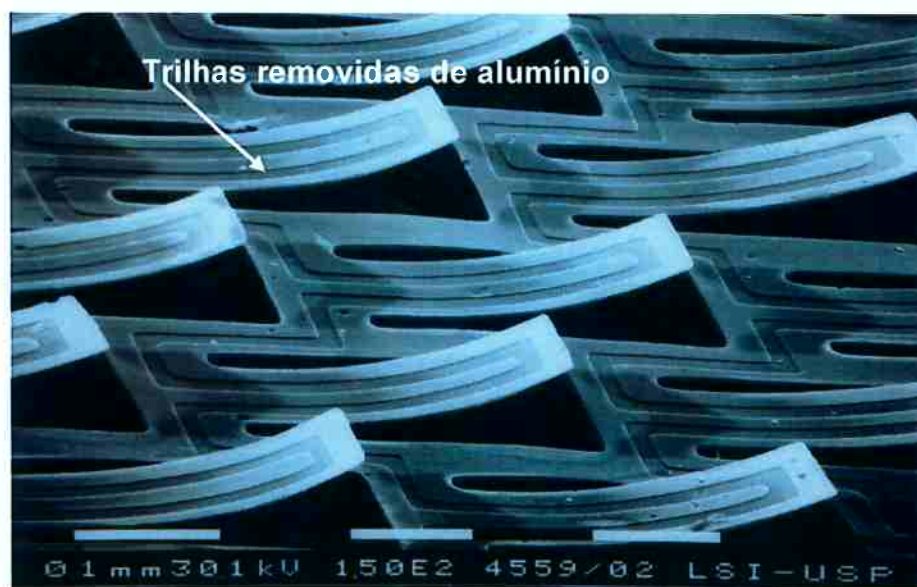
Figura 34. Cantilevers de 300 μm de comprimento de uma matriz defasada. Trilhas de alumínio foram removidas durante a corrosão em KOH.
