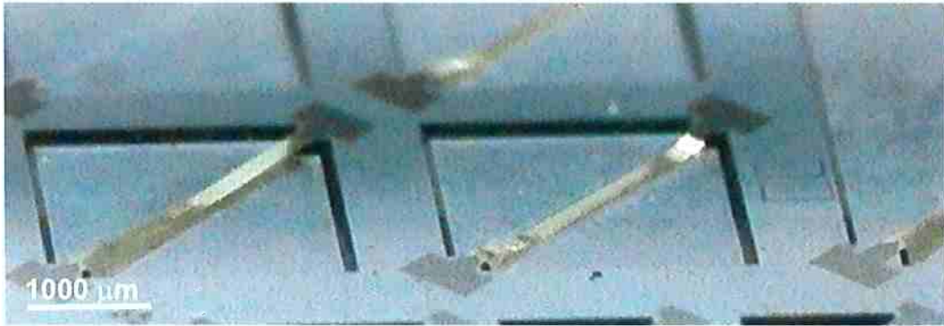
Figura 20. Micropontes de 2 mm de comprimento de a-SiC:H 3680 aderidas ao fundo da cavidade.
