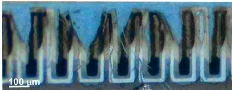
Figura 42. Deformação de cantilevers devido a correntes superiores a 22,5 mA.
