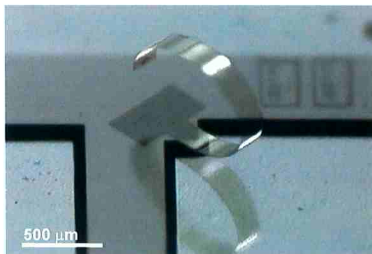
Figura 21. Ponte de 2000x160 μm envergada devido ao stress residual do filme de a-SiC:H 3690H.
