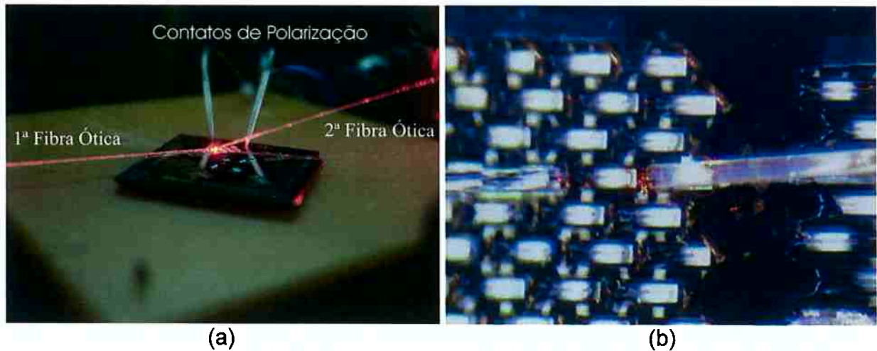
Figura 44. Montagem experimental para medida da movimentação dos cantilevers . (a) Vista geral do substrato e fibras ópticas. (b) Alinhamento das fibras ópticas.
