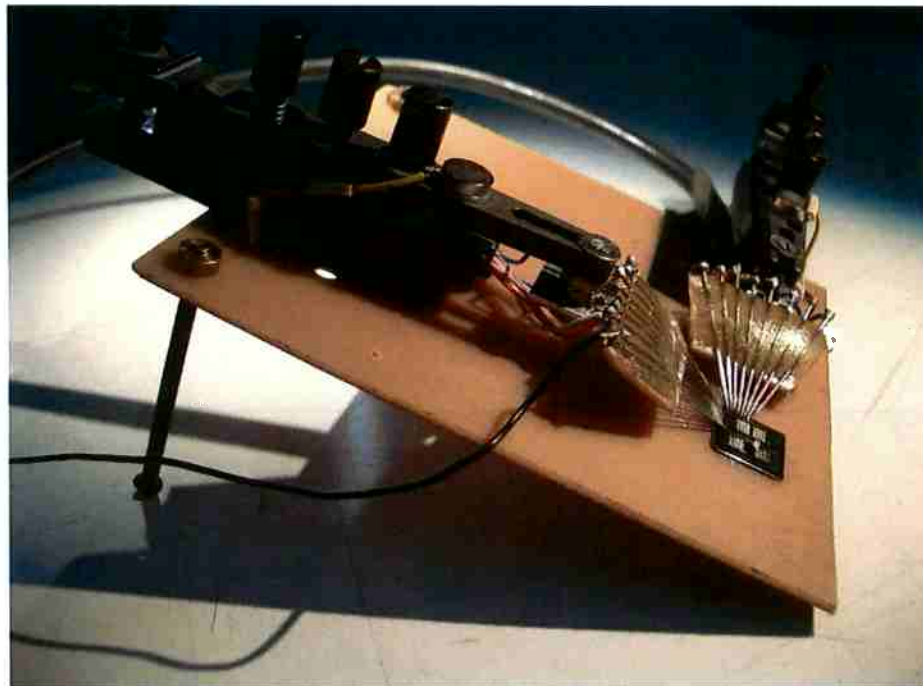
Figura 57. Suporte com microposicionadores para polarização das matrizes de dois níveis de metalização.
