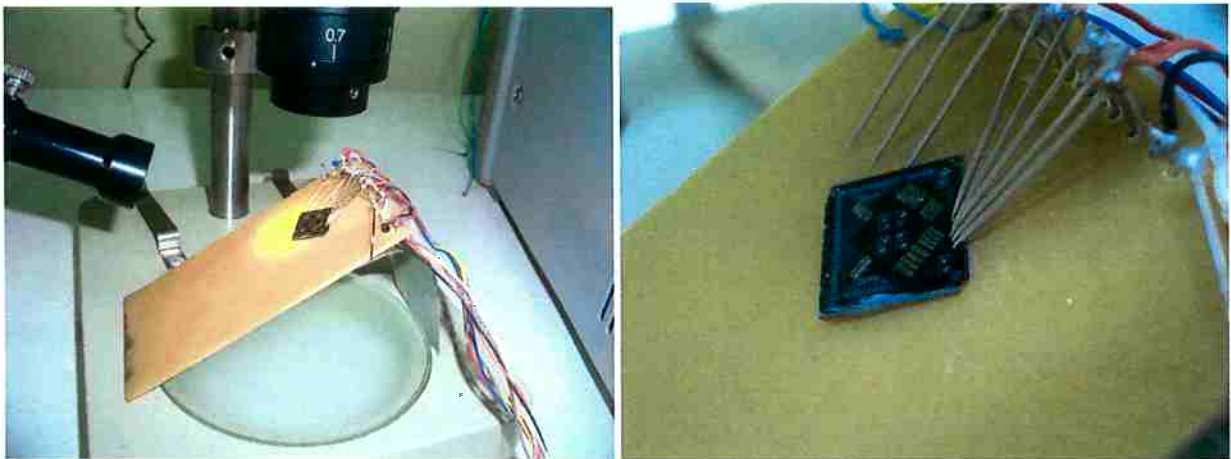
Figura 30. Configuração do sistema de polarização dos dispositivos.
