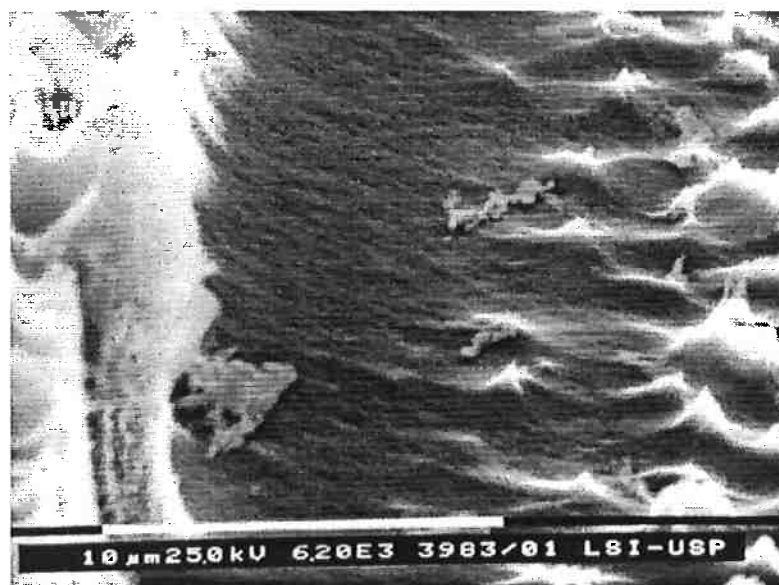
Figura 4.8: Micrografia representando a rugosidade gerada em um processo de corrosão de silício com 20 sccm de \text{CBrF}_3 , 2 sccm de Ar, 2 sccm de \text{SF}_6 , com 50 mTorr de pressão, 100 W de potência, após 30 min de processo.
