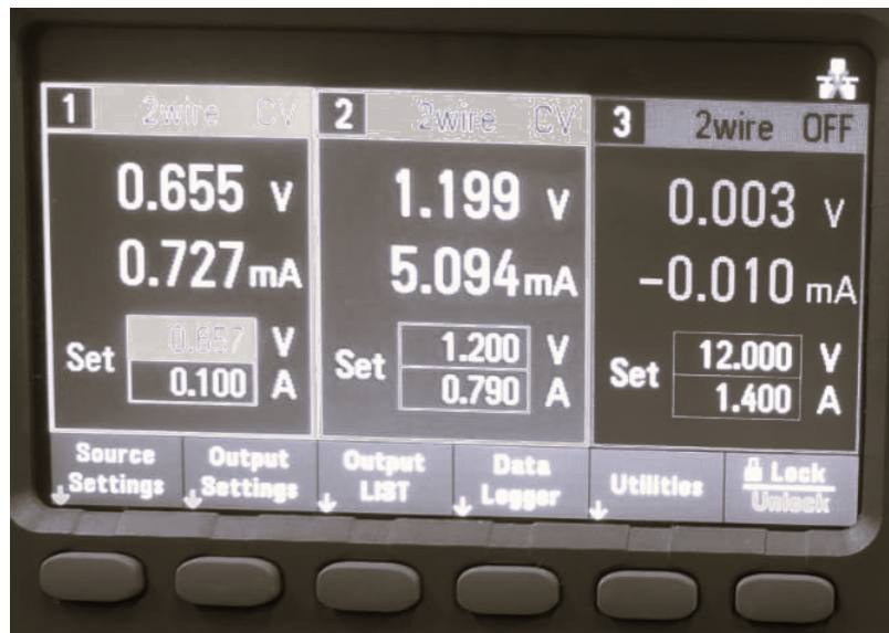
Figura 78 – Medida de tensão de alimentação e consumo de corrente do VCO cross-coupled pair com polarização adaptativa de substrato.
