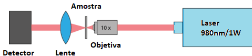
Figura 16 - Ilustração do arranjo experimental usado para medidas de transmitância em função da potência de excitação
