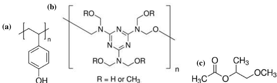
Figura 3.2 – Estrutura química dos monômeros dos polímeros utilizados como dielétrico (a) PVP, (b) PMF e (c) do solvente PGMEA. Fonte: Sigma Aldrich , (2019).
