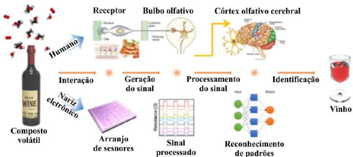
Figura 2.9 – Comparação do processo de reconhecimento de uma amostra pelo sistema biológico e eletrônico. Fonte: adaptado de [131].
