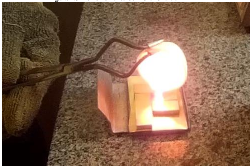
Figura 4.5 Derramamento do vidro fundido
