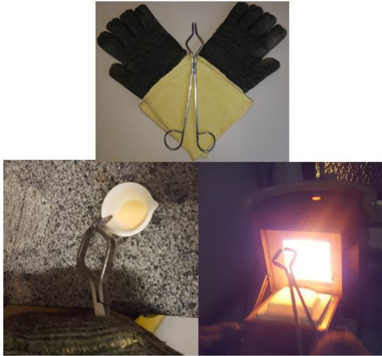
Figura 4.4 Ilustração de um cadinho de alumina com reagente sendo colocado no forno para fusão.
