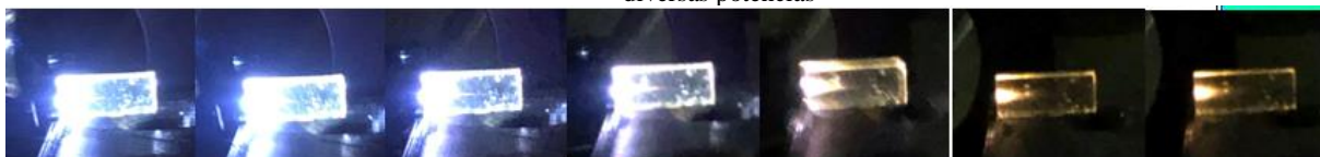
Figura 5.7 Amostra TZ 2%Yb 0,75%Tm 0,1%Ho com 0,5%AgNO 3 0h, emitindo diferentes comprimentos de ondas para diversas potências
