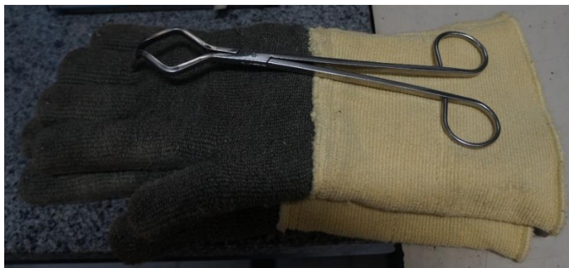
Figura 3.7 – Luvas térmicas e pinça com ponta de platina utilizado para o manuseio do cadinho com reagentes nos fornos de alta temperatura.
