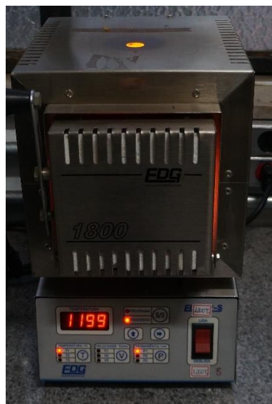
Figura 3.6 – Forno elétrico utilizado neste trabalho para fusão dos reagentes à temperatura próxima de 1200 °C.
