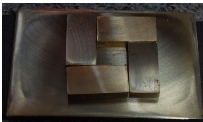
Figura 3.8 – Molde de latão ajustado para produção de amostra.
