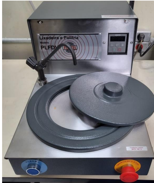
Figura 3.10 – Politriz Fortel PLFDV utilizada no polimento das amostras produzidas.
