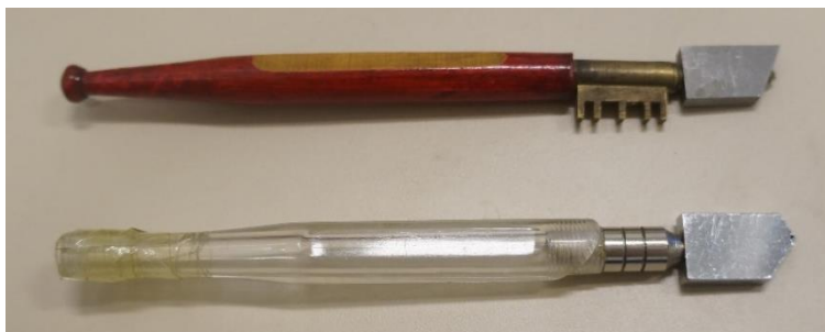
Figura 3.11 – Ferramentas de corte de vidro onde a superior apresenta corte por ponta fixa diamantada e inferior por lâmina rotativa.
