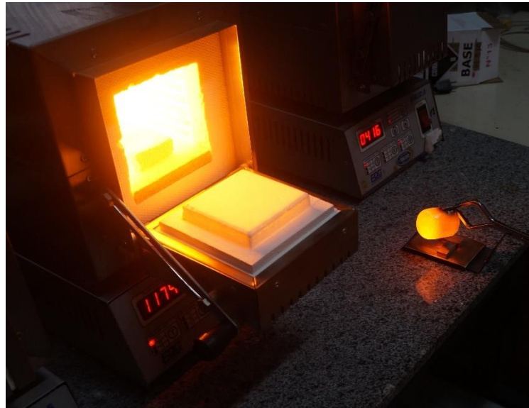
Figura 3.9 – Massa fundida sendo vertida em molde de latão.
