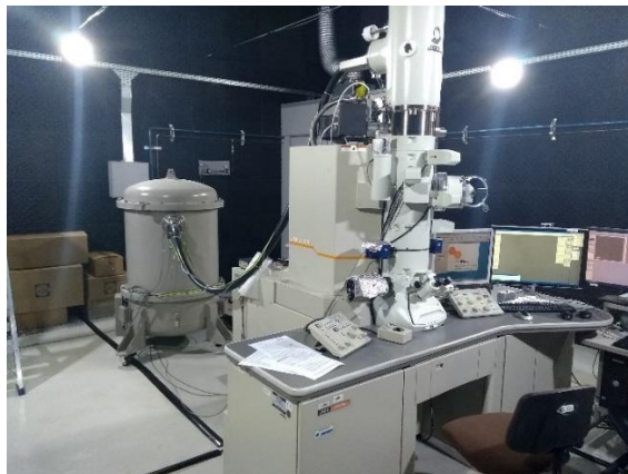
Figura 3.7 – MET utilizado na caracterização
