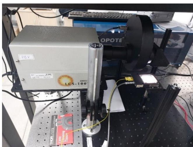
Figura 3.8 – Simulador solar; teste com célula solar de referência
