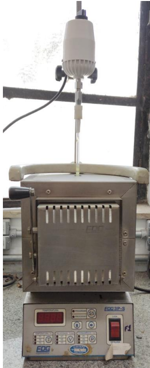
Figura 3.6 - Sistema utilizado durante a fusão com agitador mecânico
