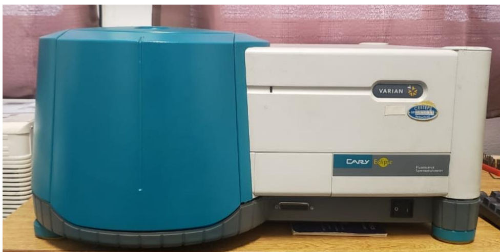
Figura 3.13 - Fluorímetro utilizado nas medidas de emissão na região do VIS
