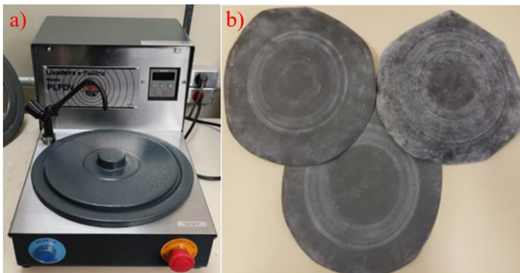
Figura 3.10 - (a) Politriz e (b) lixas d'água utilizadas
