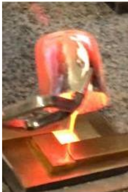
Figura 3.8 - Processo de derramamento no molde de latão
