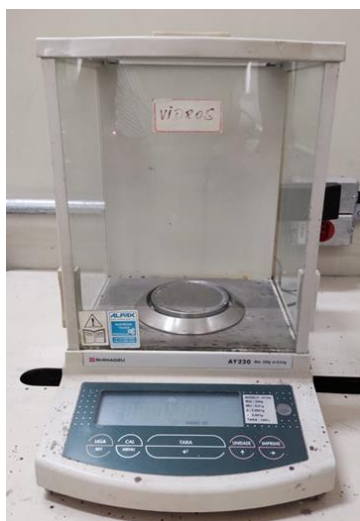
Figura 3.1 - Balança analítica utilizada na pesagem dos reagentes
