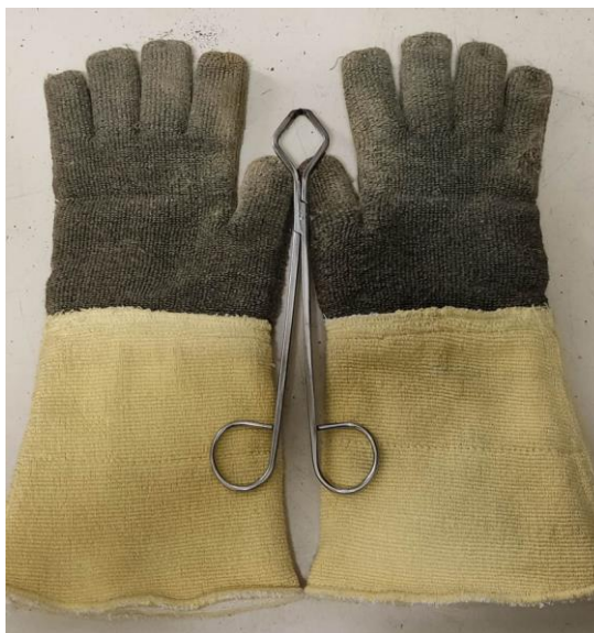
Figura 3.5 - Equipamento utilizado para manuseio das amostras fundidas
