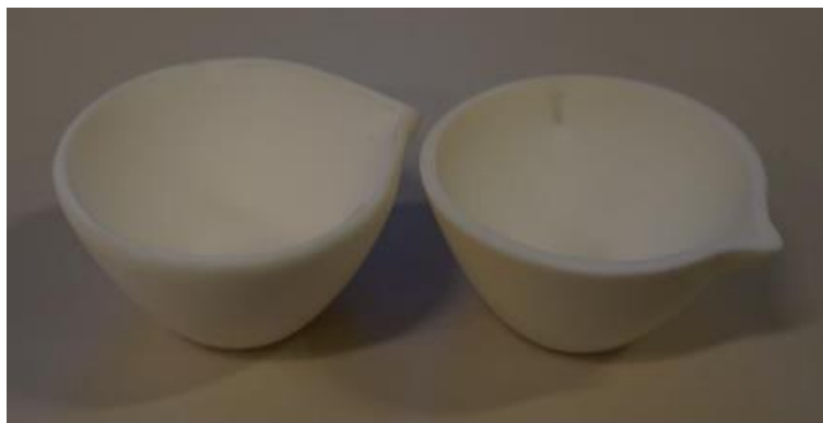
Figura 3.4 - Cadinhos de alumina utilizados na preparação das amostras
