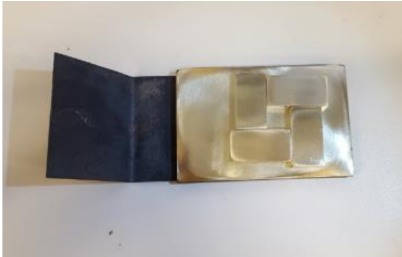
Figura 3.7 - Molde de latão polido utilizado para resfriamento e tratamento térmico
