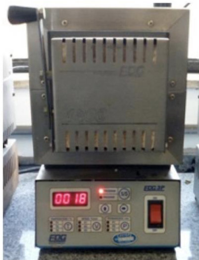
Figura 26 - Forno utilizado para a fusão dos reagentes.
