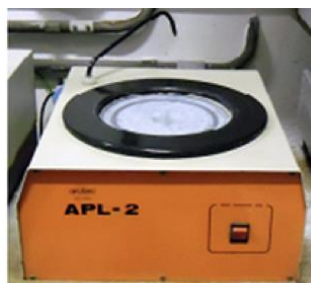
Figura 29 – Em (a) Politriz Universal Arotec APL-2 e (b) lixa d'água de granulação 400 usada na primeira etapa do polimento.
