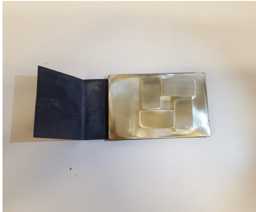
Figura 27 - Molde de latão usado para o tratamento da amostra.
