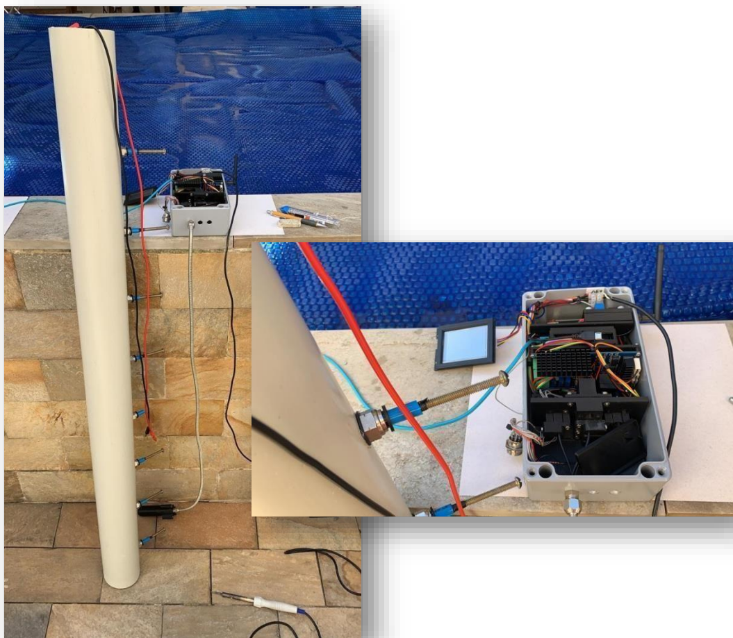
Figura 16 - Tubo de ensaio da sonda de temperatura em multiprofundidades e protótipo do equipamento MPMS.
