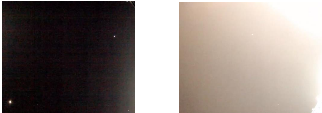
Figura 20 - À esquerda, captura de imagem de uma câmera de filmagem no visível em voo suborbital. À direita, a mesma cena com leve deslocamento angular poucos segundos depois, após o início da entrada do Sol no campo de visada pelo canto superior direito.
