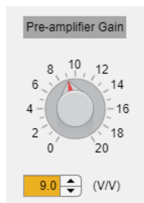
Figura 63 - Ganho do detector especificado pelo modelo do detector e que varia em função da temperatura
