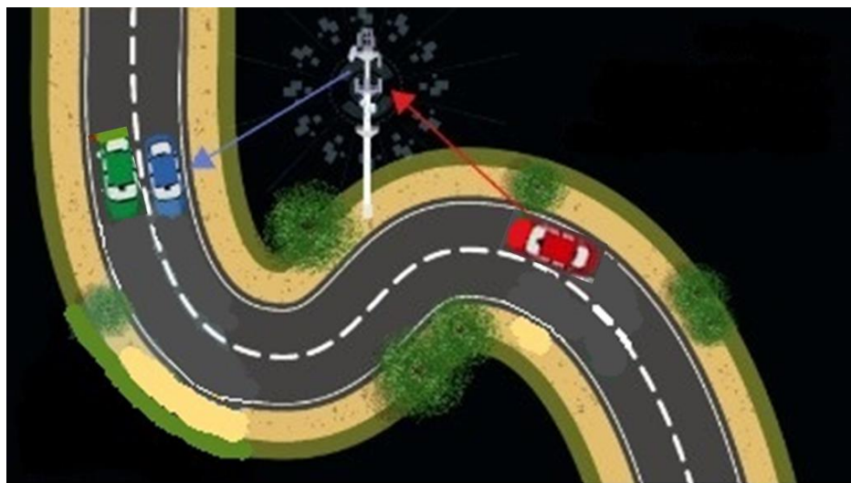
FIGURA 69 EXEMPLO DE MANOBRA DE ULTRAPASSAGEM COM SUPORTE
