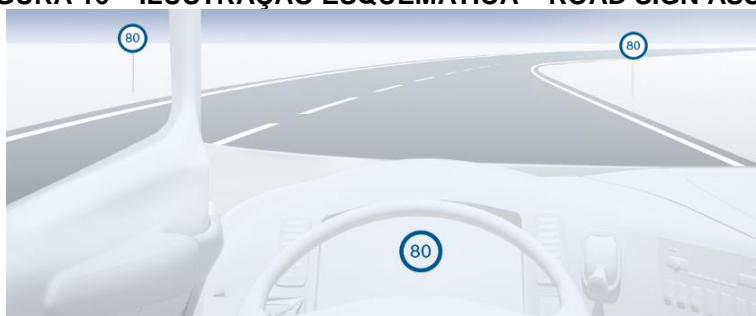
FIGURA 16 – ILUSTRAÇÃO ESQUEMÁTICA – ROAD SIGN ASSIST
