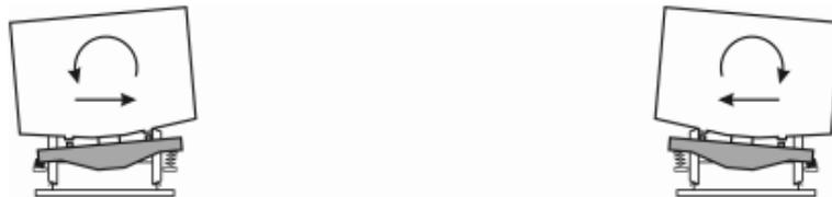
Figura 9 – Representação do movimento oscilatório de rolagem combinado com rolagem lateral
