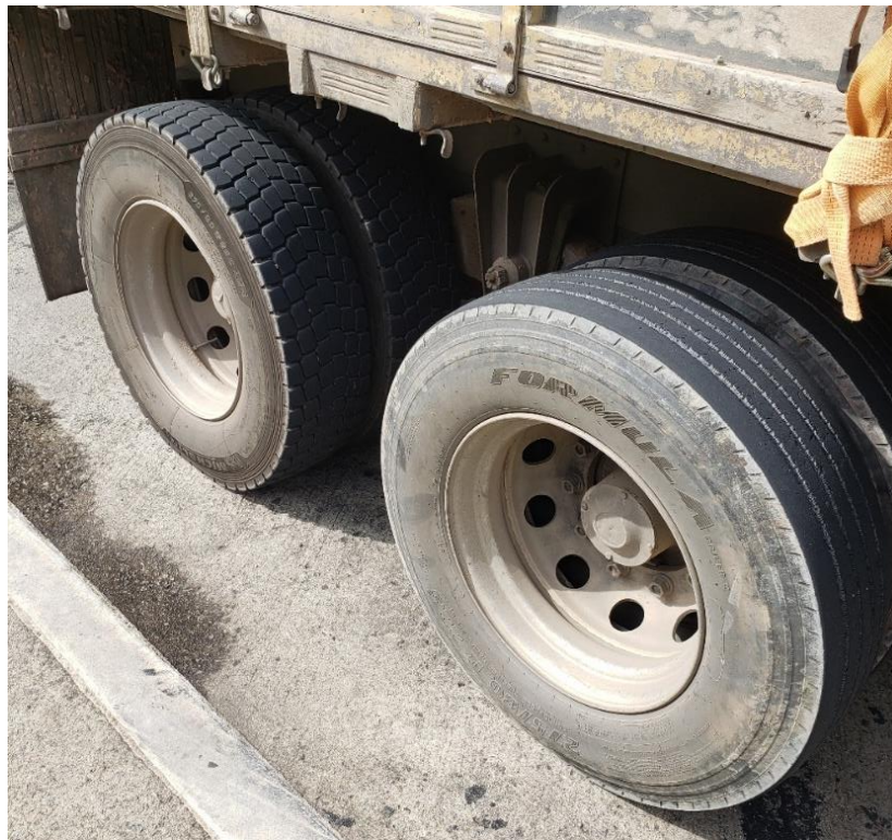
Figura 23 - Eixo tandem duplo com diferença na banda de rodagem
