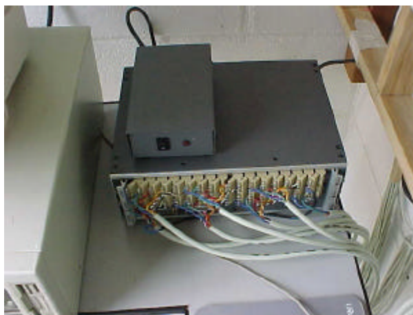
Foto 6.21 Condicionador de sinais e conversor analógico-digital
