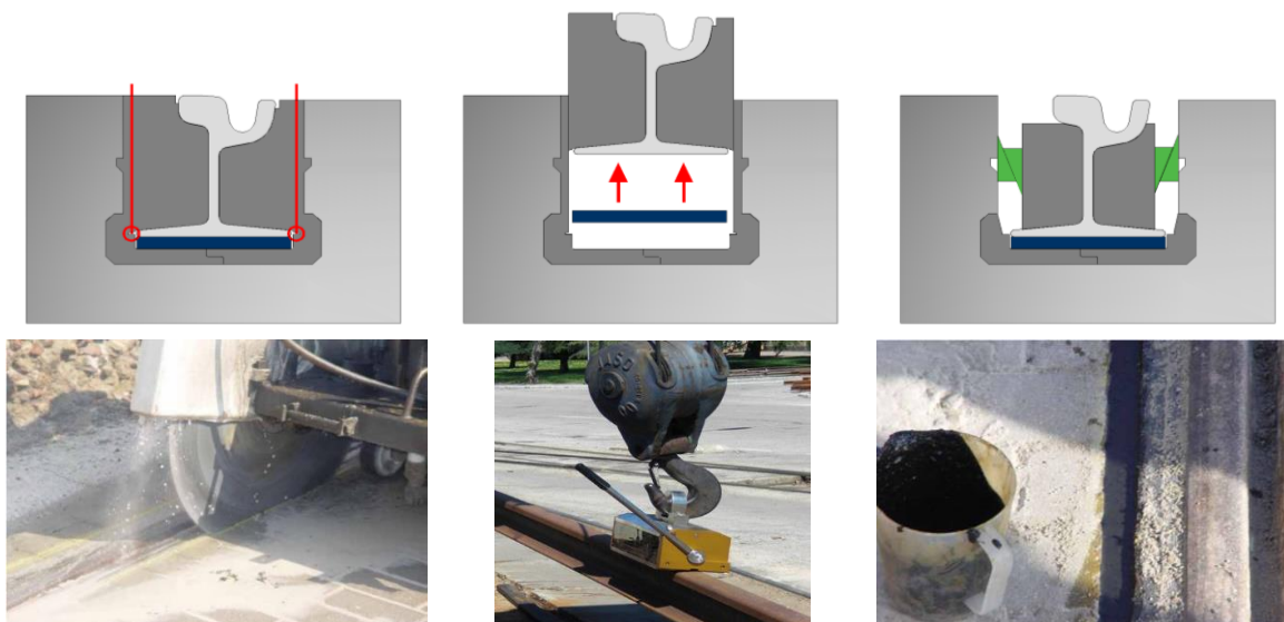
Figura 10 - Sequência executiva para a substituição de trilhos - Sistema CDM. Fonte: Pandrol
