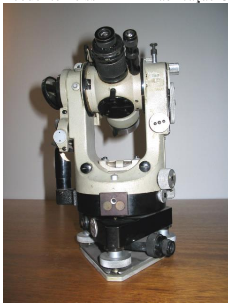
Figura 5.16 – Teodolito Zeiss Th III – Fabricação Carl Zeiss Jena.
