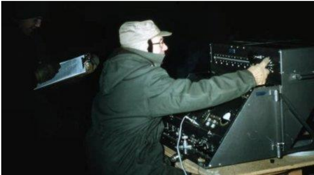
Figura 5.12 – Medição noturna com Geodímetro AGA NASM-2.
