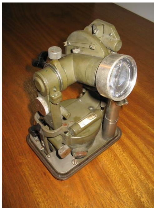
Figura 5.14 – Teodolito Kern DKM 2 – Fabricação Kern.
