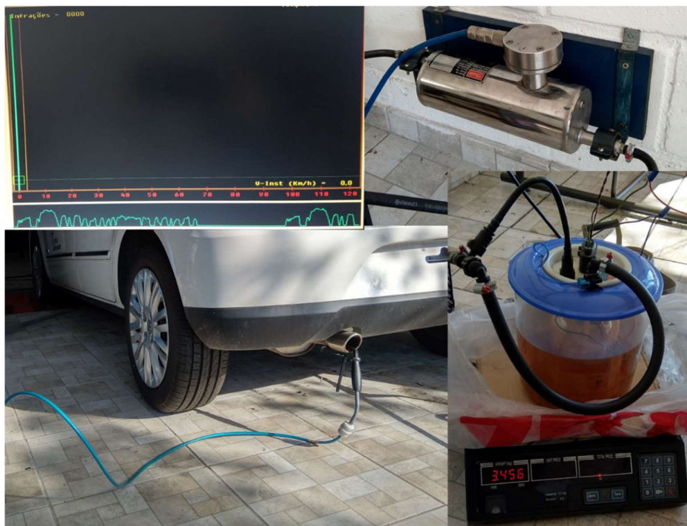
Figura 42 – Medição de consumo de combustível e emissões no ciclo FTP-75 aquecido
